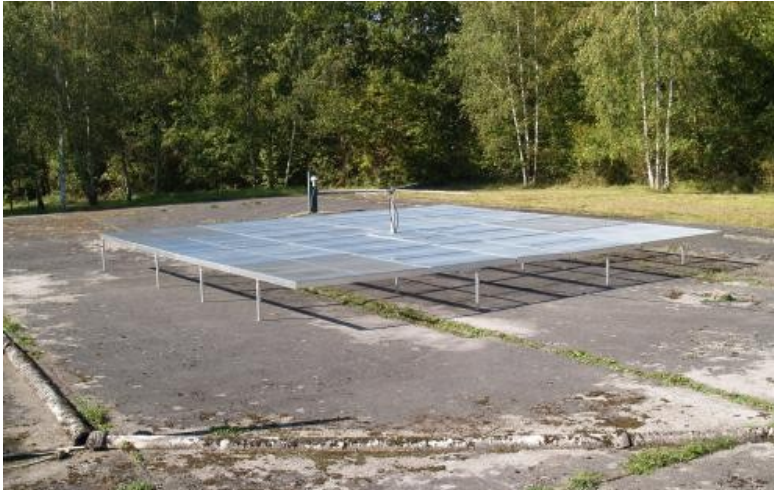
Abb. 10 Modifizierte GP Antenne der BRAMS Bake (Bild: [12])
